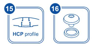
Важно: запрещается использовать любые акрилосодержащие герметики! Нельзя смазывать различными маслами и смазками места введения поликарбонатных листов в профили, т.к. это приводит к разрушению материала в месте соединения.
